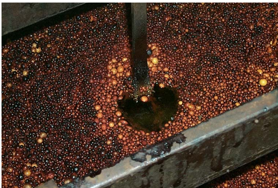
Figura 27: Foto da empresa E 03 mostrando a fina camada de esferas de poliestireno expandido depositadas sobre o banho eletrolítico de cromação no primeiro dia de avaliação
