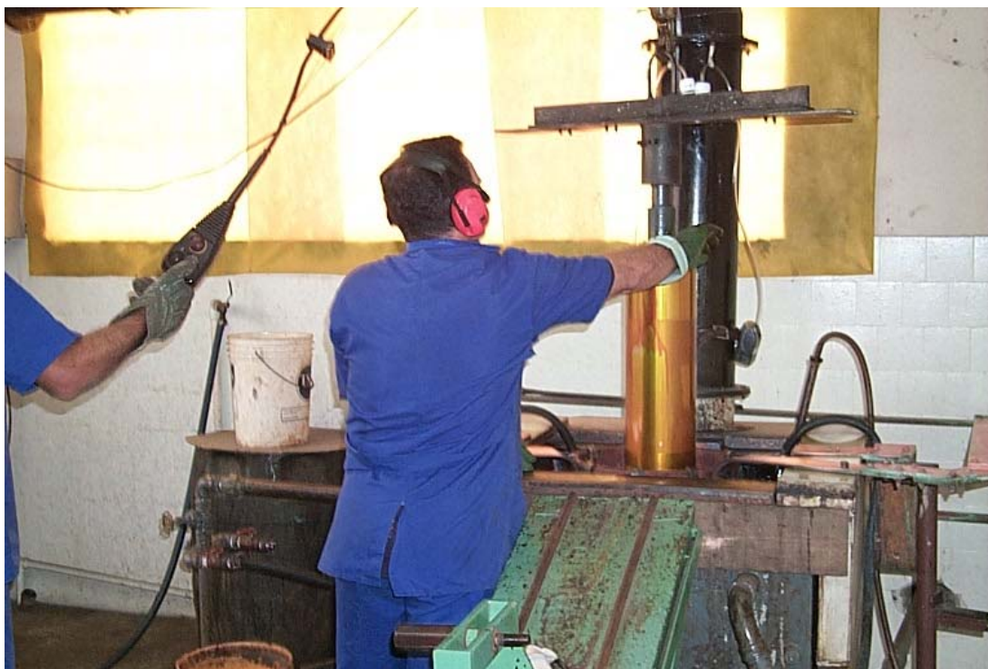
Figura 62: Foto mostrando um cilindro - após a deposição eletrolítica - ser retirado de dentro do tanque na empresa E 09
