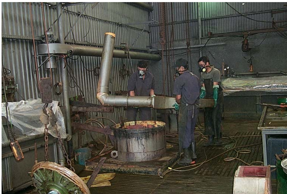
Figura 66: Foto mostra trabalhadores retirando o sistema de ventilação para a colocação de uma peça grande dentro do tanque cilíndrico de eletrodeposição na empresa E 10
