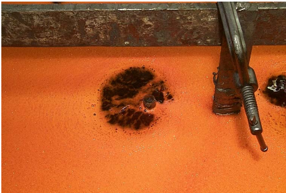
Figura 7: Foto da empresa E 01 mostra um banho eletrolítico de cromação que utiliza espuma supressora tensoativa em sua superfície
